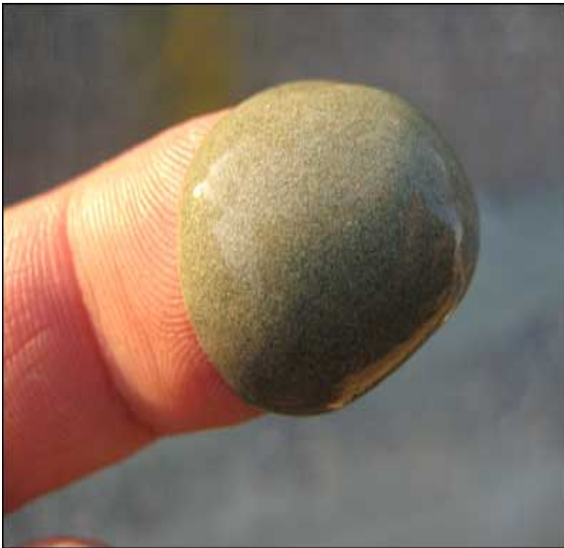
High Moisture Content Silt
